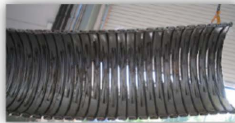
Рисунок 8 - Структура гибкого трубопровода со стальным каркасом (слева), типичное повреждение каркаса, вызванное эрозией (справа)
