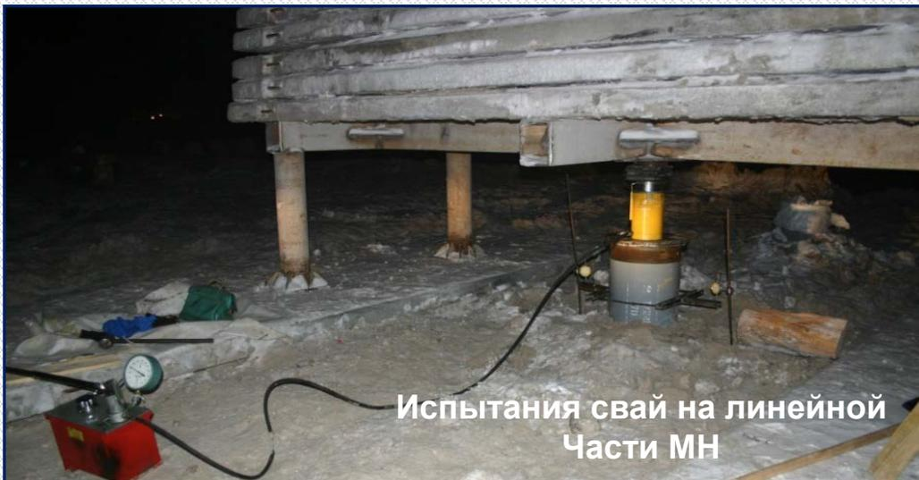
Испытания свай на линейной Части МН
