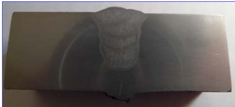
Макрошлиф сварного соединения
