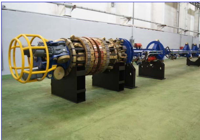
Сварочная машина для КСО корневого слоя шва
