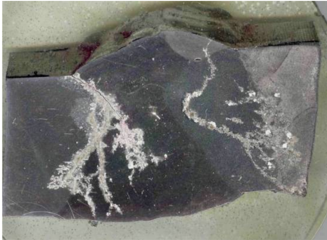
Ртутная коррозия алюминиевого теплообменника
