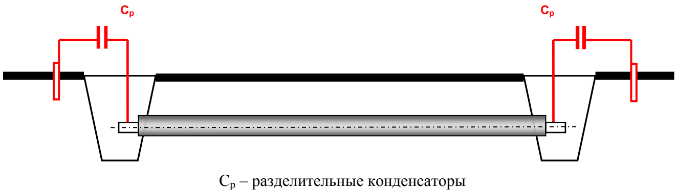
Рисунок Г.3 – Схема заземления трубопровода при снижении индуцированного напряжения
